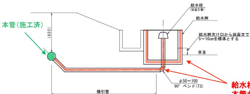
給水栓の工事内容は、**本管からの横引き管と給水樹の設置**です。
