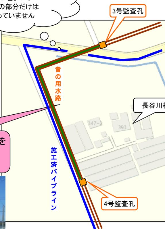
3号監査孔と4号監査孔との間の昔の用水路を流動化処理土という泥が固まる材料で閉塞しました。
